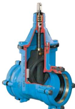
**HAWLE-Schieber 4041E2**, Verbindungssystem 2000, weichdichtender Keilschieber mit Flansch und Steckmuffe für PE und PVC-Rohre. Nenndruck: PN 16, DIN 8074/8062
