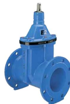
**HAWLE-Schieber 4040E2**, Verbindungssystem 2000, weichdichtender Keilschieber mit Steckmuffe für PE und PVC-Rohre. Nenndruck: PN 16, DIN 8074/8062, absolut zugfest, beidseitig gemufft
