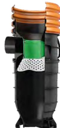
Kombination Nassschlamm-Straßenablauf mit Grobfilter und Einlaufstutzen
