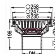
**Kellerablauf aus ABS DN 100**, Auslauf seitlich 2,5°, Klasse K 3, mit herausnehmbarem Doppelrückstauverschluss und handverriegelbarem Notverschluss und Schlammeimer
