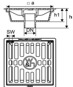
**FERROTECH® Serie P1018 Bodenablauf DN 70**
