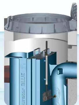
Schlauchvorrichtung zur Probenentnahme kleine Baureihe
