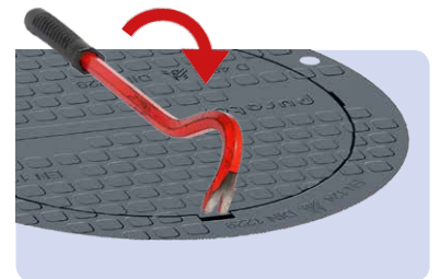
Abb. C: Mit entsprechendem Werkzeug und einem kräftigem Ruck Arretierung lösen
