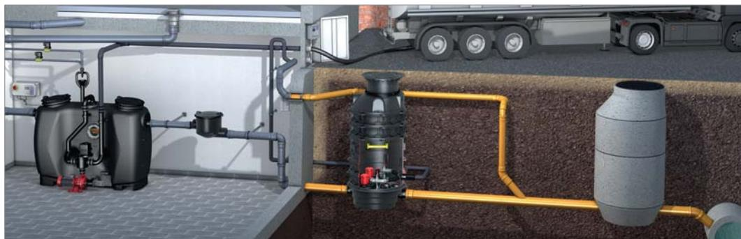
Die Rückstauhebeanlage *Ecolift XL* kann neben der freien Aufstellung auch in einer Betonplatte oder im Erdreich verbaut werden. Das Technikmodul wird dabei mit einem grundwasserbeständigen Schachtmodul kombiniert. Im abgebildeten Anwendungsfall wurde die Rückstauhebeanlage hinter einem Fettabscheider installiert, dies ist natürlich auch im Anschluss an einen Öl-, Benzinabscheider möglich.
