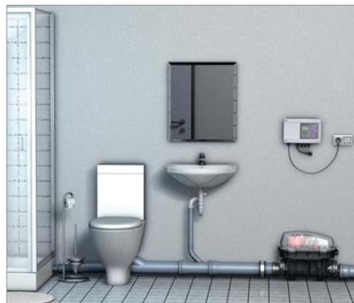
Für den privaten Einsatz. Abwasserentsorgung über natürliches Gefälle zum Kanal. Pumpt Abwasser trotz Rückstau zum Kanal mit Bypass-Druckleitung unterhalb der Rückstauene.
