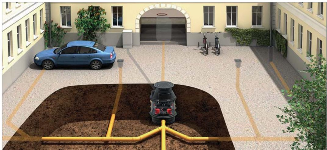
Eingebaut außerhalb des Gebäudes im KESSEL-Technikschacht. *Ecolift XL* ist leise, pumpt nur bei Rückstau vom Kanal – also ökonomisch, sicher und einfach zu verbauen.
