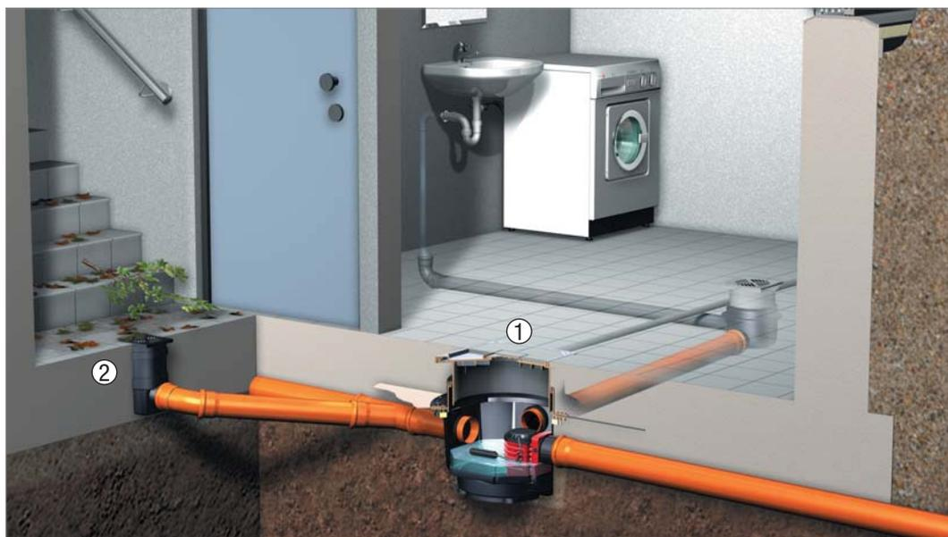
Der Kellerablauf für Schmutzwasser, mit Rückstaudoppelverschluss und Pumpe. Mit befließbarer Abdeckung und Bodenablauffunktion ①. Für die vollautomatische Kellerentwässerung bei freiem Gefälle zum Kanal.
