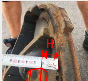
richtige vertikale Pos.: Abstand Vorderkante des Federstabes zur Deckelauflagefläche entspr. dem Maß H in Abb.6.
