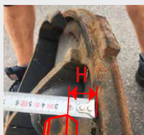
richtige vertikale Pos.: Abstand Vorderkante des Federstabes zur Deckelauffläche entspr. dem Maß H in Abb.6.
