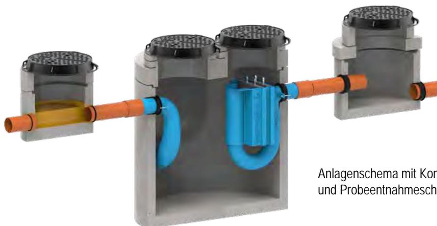
Anlagenschema mit Kontrollschacht davor und Probeentnahmeschacht dahinter
