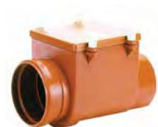
**Rückstauverschluss** mit automatisch wirkender Edelstahlklappe, zusätzlicher Handabspernung und Reinigungsöffnung
