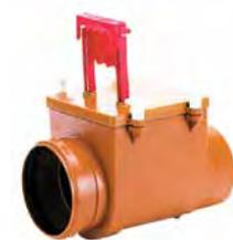
**Senkrechter Rückstauverschuß** mit Handabspernung automatisch wirkende Edelstahlklappe mit integriertem Auftriebskörper, zusätzlicher Handabspernung und Reinigungsöffnung
