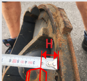
richtige vertikale Pos.: Abstand Vorderkante des Federstabes zur Deckelauflegefläche entspr. dem Maß H in Abb.6.
