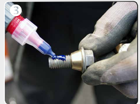
Flüssige Schraubensicherung auf Gewinde wie dargestellt auftragen Schrauben dürfen nicht eingefettet sein
