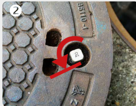
2 Riegel beim losen Deckel gegen den Uhrzeigersinn bis zum Anschlag drehen, um den Deckel in den Rahmen setzen zu können
