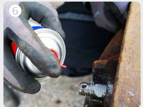
6 Gewinde des Bolzens sorgfältig mit Schmierfett einfetten Schrauben-Sicherungs-Kleber nicht verwenden
