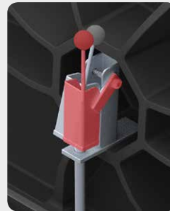
Abb. C: Schrauben lösen, Deckelheber befestigen, Deckel ganz bis zum Anschlag öffnen
