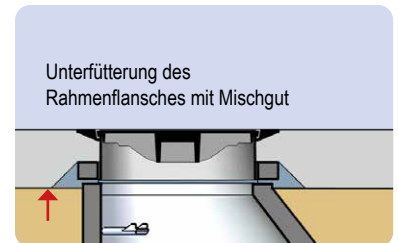
Abb. 2: Einbau der Schachtabdeckung in die erste Belagschicht
