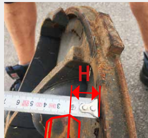
richtige vertikale Pos.: Abstand Vorderkante des Federstabes zur Deckelaufgabe entspr. dem Maß H in Abb.6.
