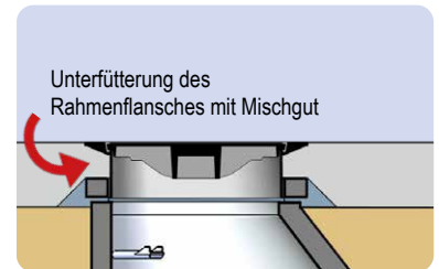
Abb. 2: Einbau der Schachtabdeckung in die erste Belagschicht
