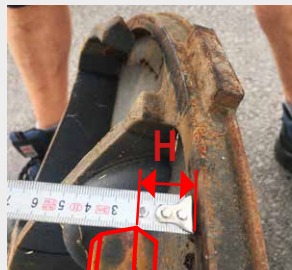
richtige vertikale Pos.: Abstand Vorderkante des Federstabes zur Deckelauffläche entspr. dem Maß H in Abb.6.
