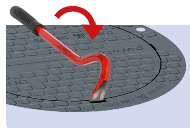
Abb. C: Mit entsprechendem Werkzeug und einem kräftigem Ruck Arretierung lösen
