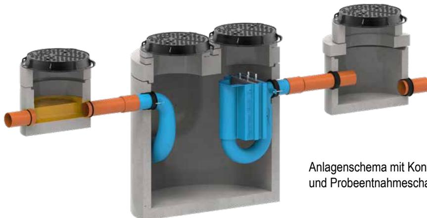
Anlagenschema mit Kontrollschacht davor und Probeentnahmeschacht dahinter
